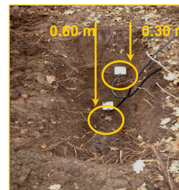
Distribuzione dell'umidità del suolo, a scala d'evento, lungo il transetto alle due differenti profondità
